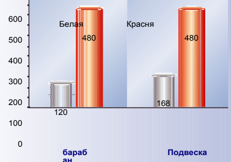
Черная пассивация без Cr(VI) с защитным покрытием: CorroTriBlack ZnFe + Corrosil Plus 501 BG
